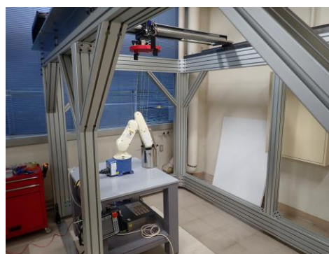
図2 クレーンとロボットアームによる注湯作業
